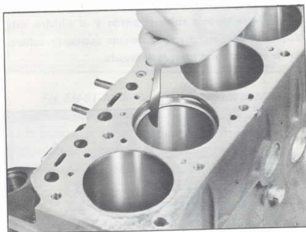
Fig. EM-56 Medición de la separación del segmento
