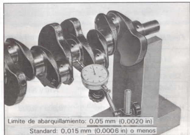
Fig. EM-63 Comprobación del abarquillamiento del árbol del cigüeñal
