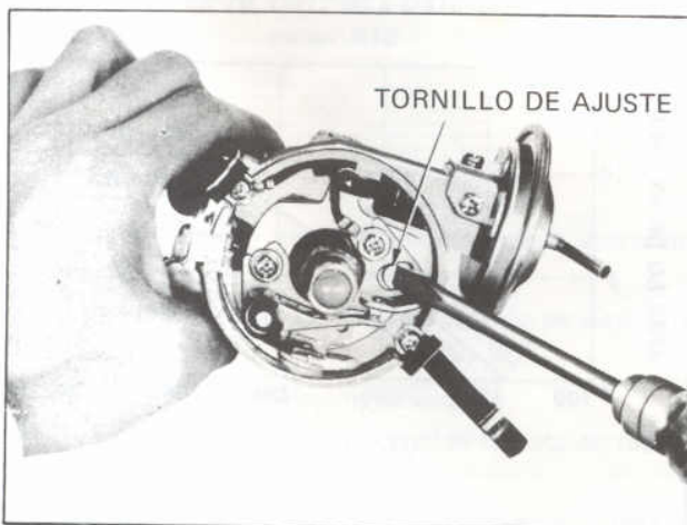
Fig. EE-63 Ajuste de la separación de las puntas
