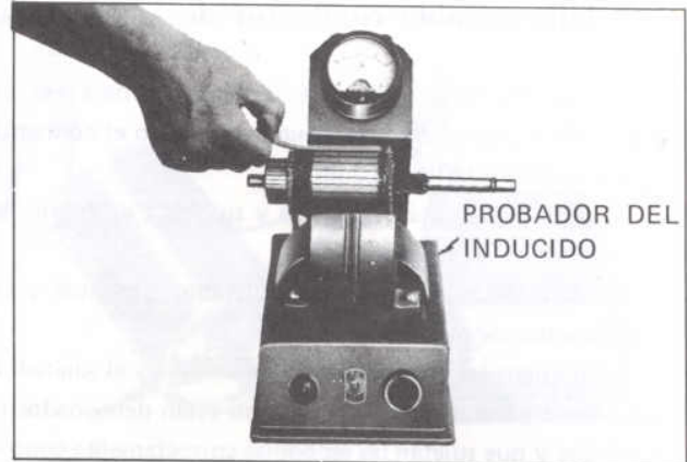
Fig. EE-18 Prueba del inducido para ver su corto-circuito
