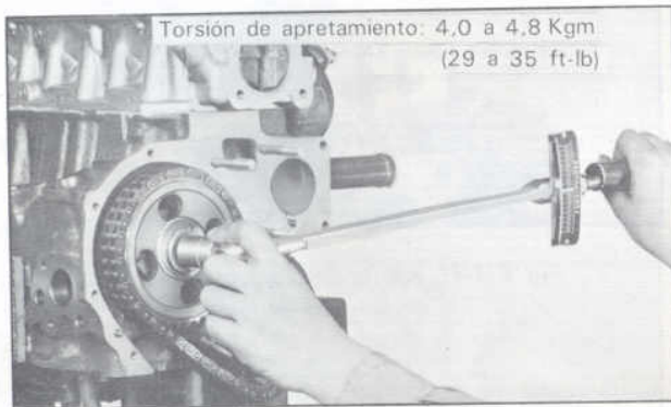
Fig. EM-81-3 Instalación del engranaje de la rueda de la cadena de la leva
