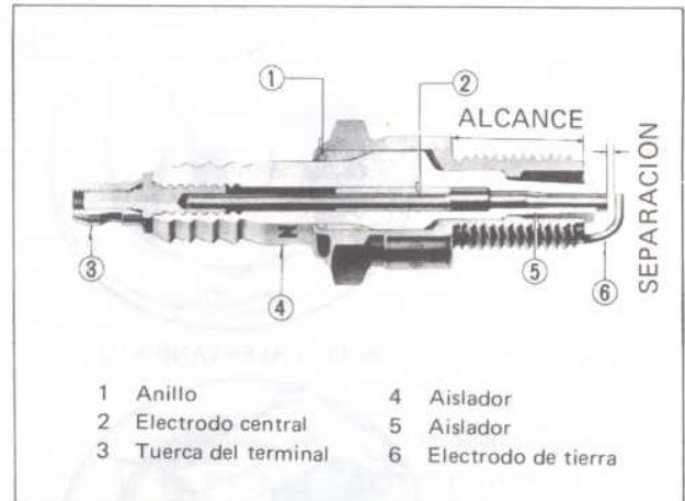
Fig. EE-82 Sección transversal de la bujía de encendido
