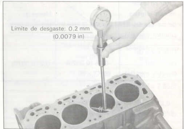
Fig. EM-49 Medición del calibre del cilindro
