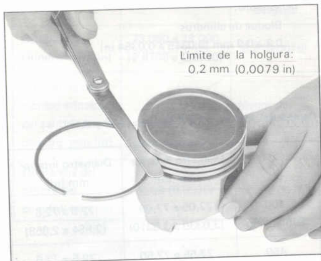
Fig. EM-55 Medición de la holgura lateral
