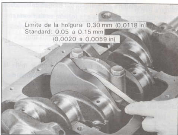
Fig. EM-64 Comprobación del juego del extremo del árbol del cigüeñal
