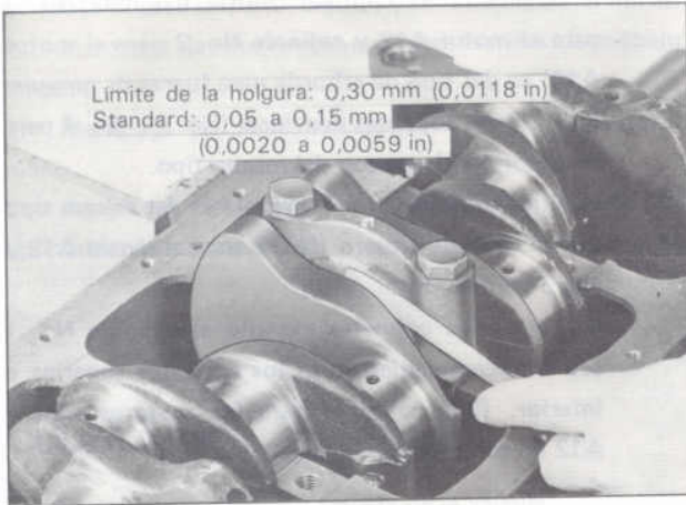
Fig. EM-76 Comprobación del juego del extremo del árbol del cigüeñal
