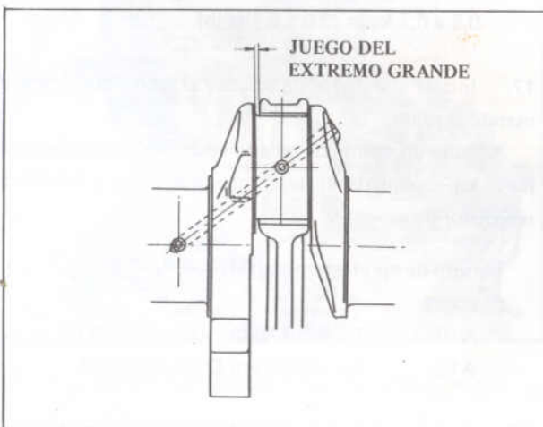
Fig. EM-80 Comprobación del juego del extremo grande
