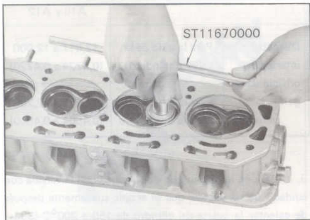
Fig. EM-42 Corrección del asiento de la válvula
