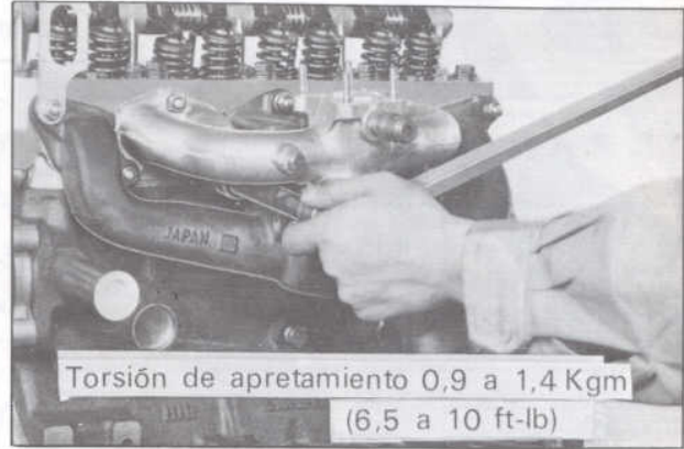
Fig. EM-87 Instalación de los colectores de admisión y escape
