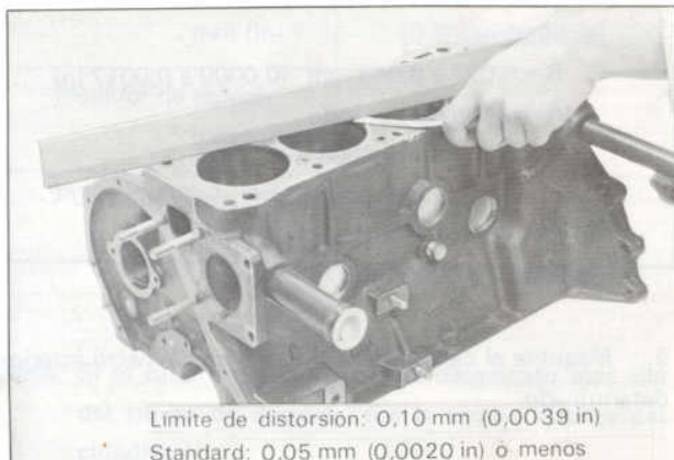
Fig. EM-48 Comprobación de la superficie del bloque de cilindros
