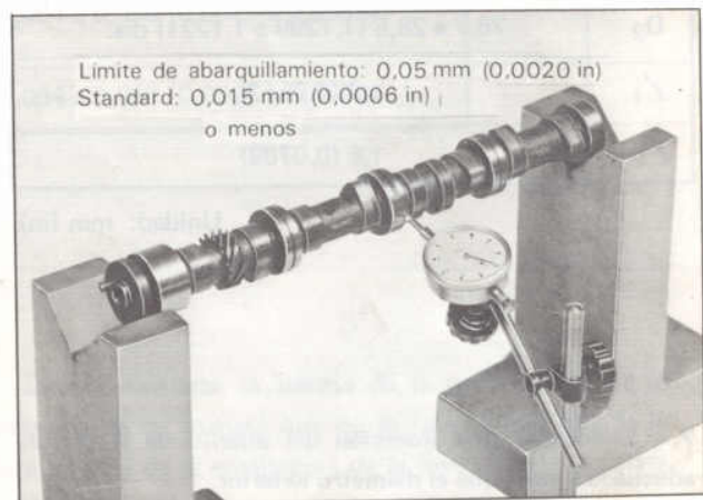
Fig. EM-47 Comprobación del abarquillamiento del árbol de levas
