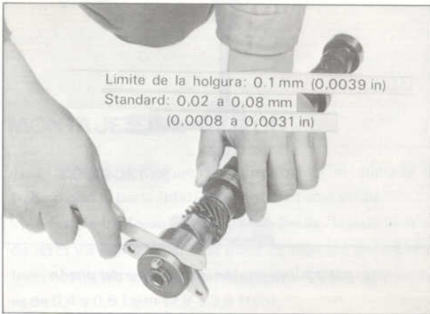
Fig. EM-70-1 Comprobación de la holgura de empuje de la placa de ubicación
