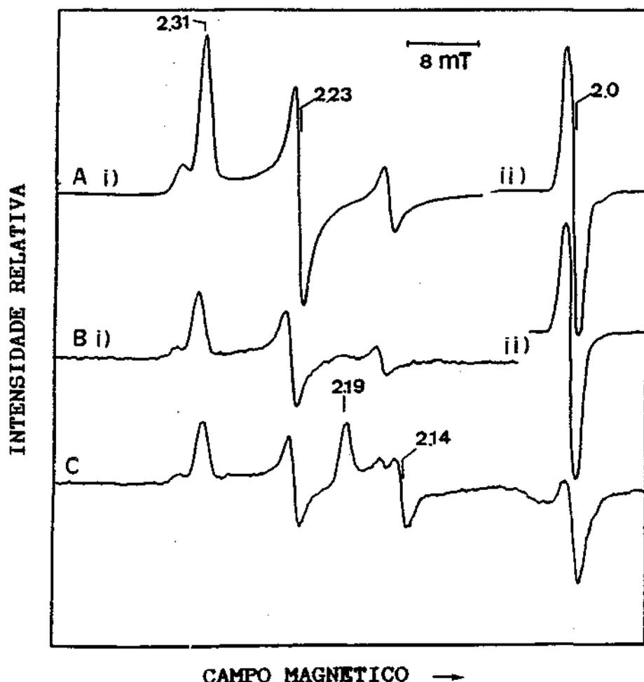
Figura V.18- Sinais de RPE de estados intermediários de redução da hidrogenase de *D.gigas* obtidos sob H<sub>2</sub> (B) ou com ditionito de sódio (C). (A)-Enzima nativa Temperatura: 11 K; Potência: 30 W; Modulação: 1 mT; Ganho: A) i)  $8 \times 10^3$ , ii) 50; B) -i)  $1,6 \times 10^4$ , ii)  $1,25 \times 10^3$  C)  $1,6 \times 10^4$
