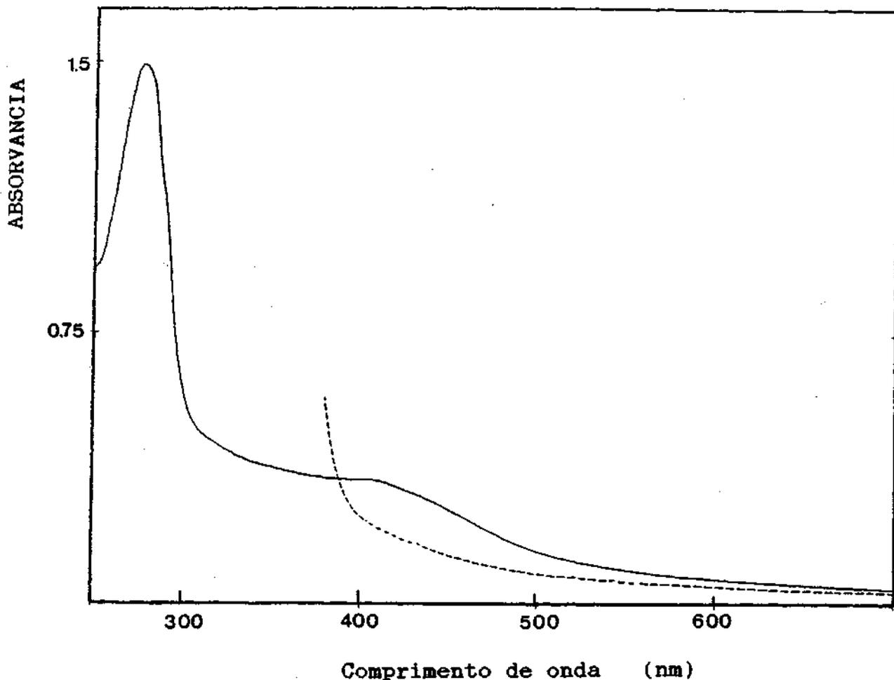
Figura V.1- Espectro de visível e ultravioleta da hidrogenase nativa de *D. gigas*, nativa (—) e reduzida com ditionito de sódio (-----)
