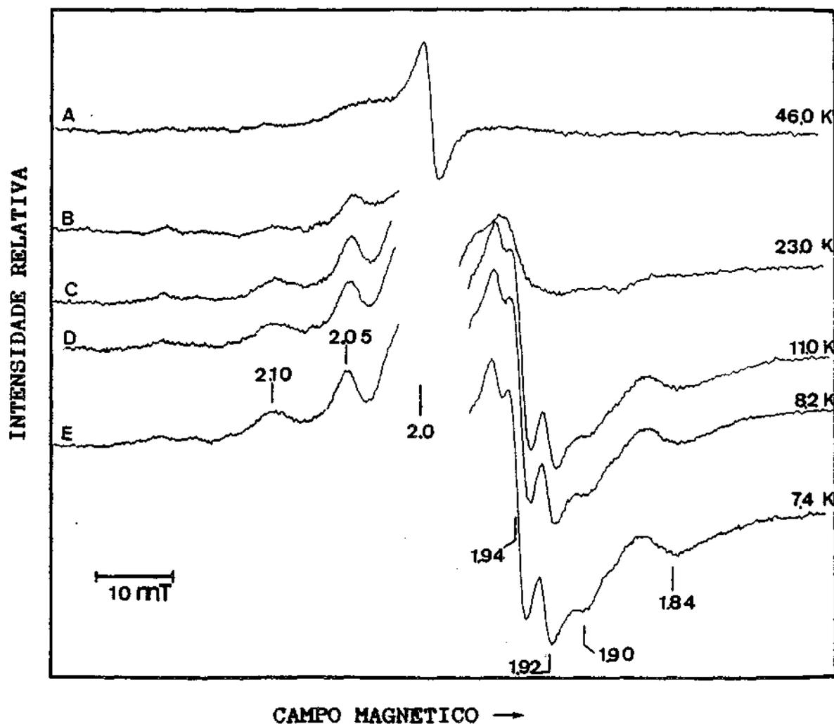
Figura V.20: Sinais de RPE da hidrogenase de *D. gigas* reduzida com excesso de ditionito de sódio
