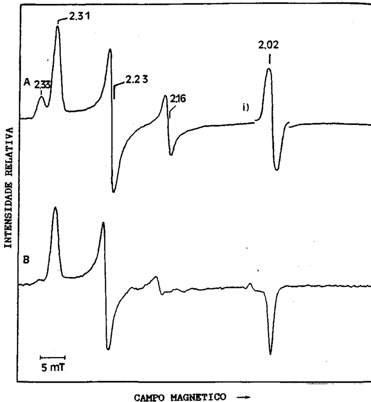
Figura V.2- Espectros de RPE da hidrogenase de *D.gigas*
