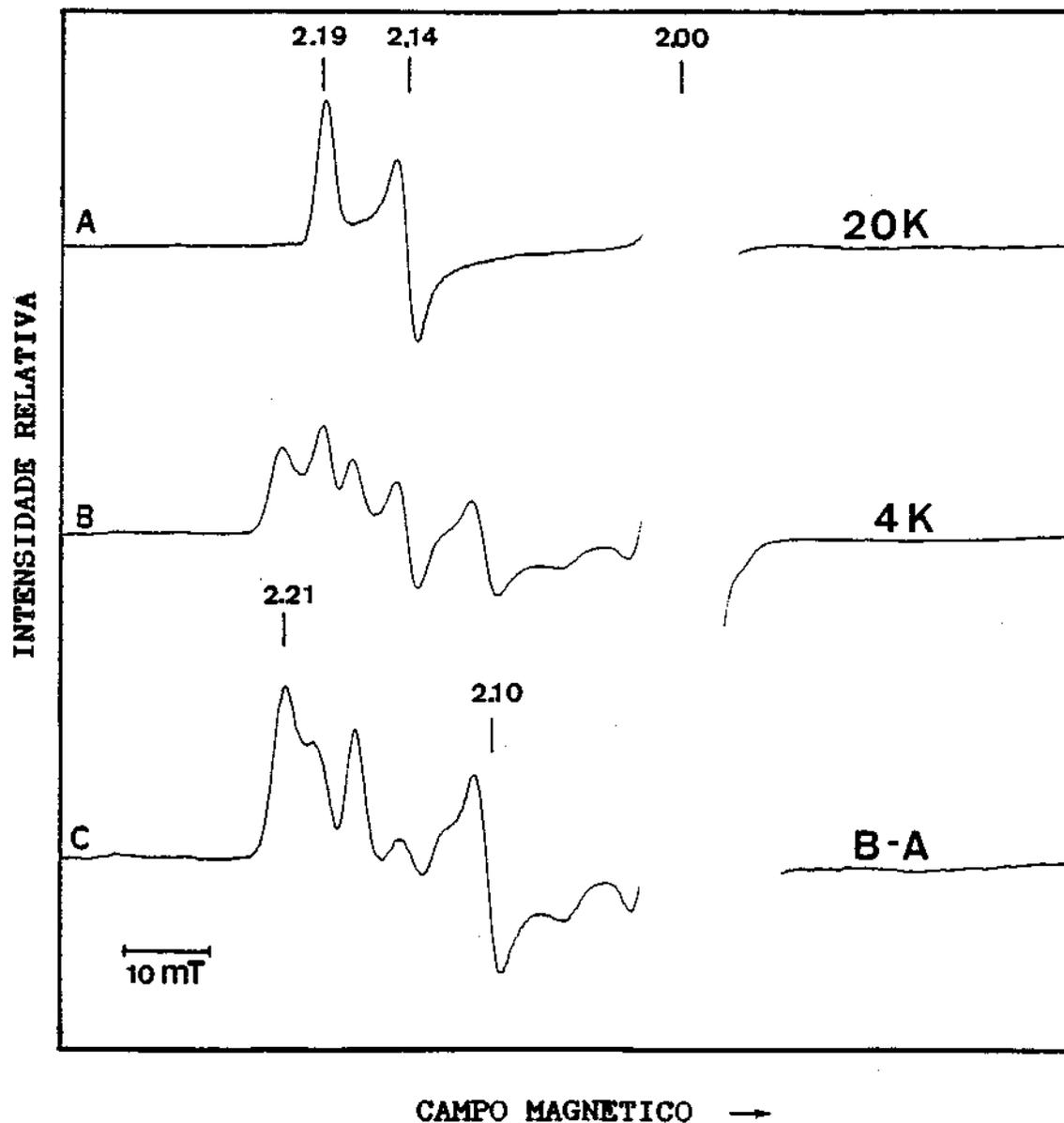
**Figura V.41:** Sinais de RPE a 20(A) e 4 K (B) da hidrogenase de *D.gigas* a -353 mV. C- Espectro de diferença B-A
