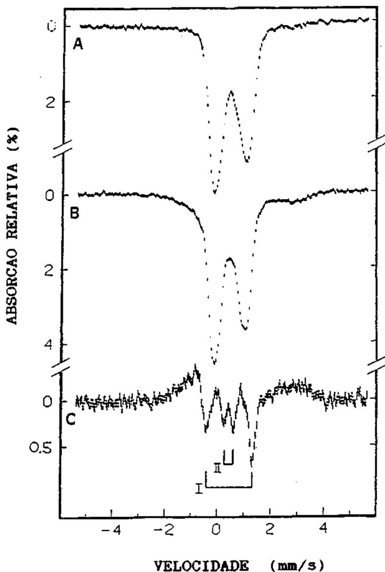
Figura V.24: Espectro de Mössbauer da hidrogenase de *D.gigas* a -80 mV, na ausência de campo magnético (A) e na presença de um campo de 50 mT aplicado paralelamente à radiação  $\gamma$  (B) O espectro C é o espectro de diferença de A e B Temperatura: 4,2 K (9)
