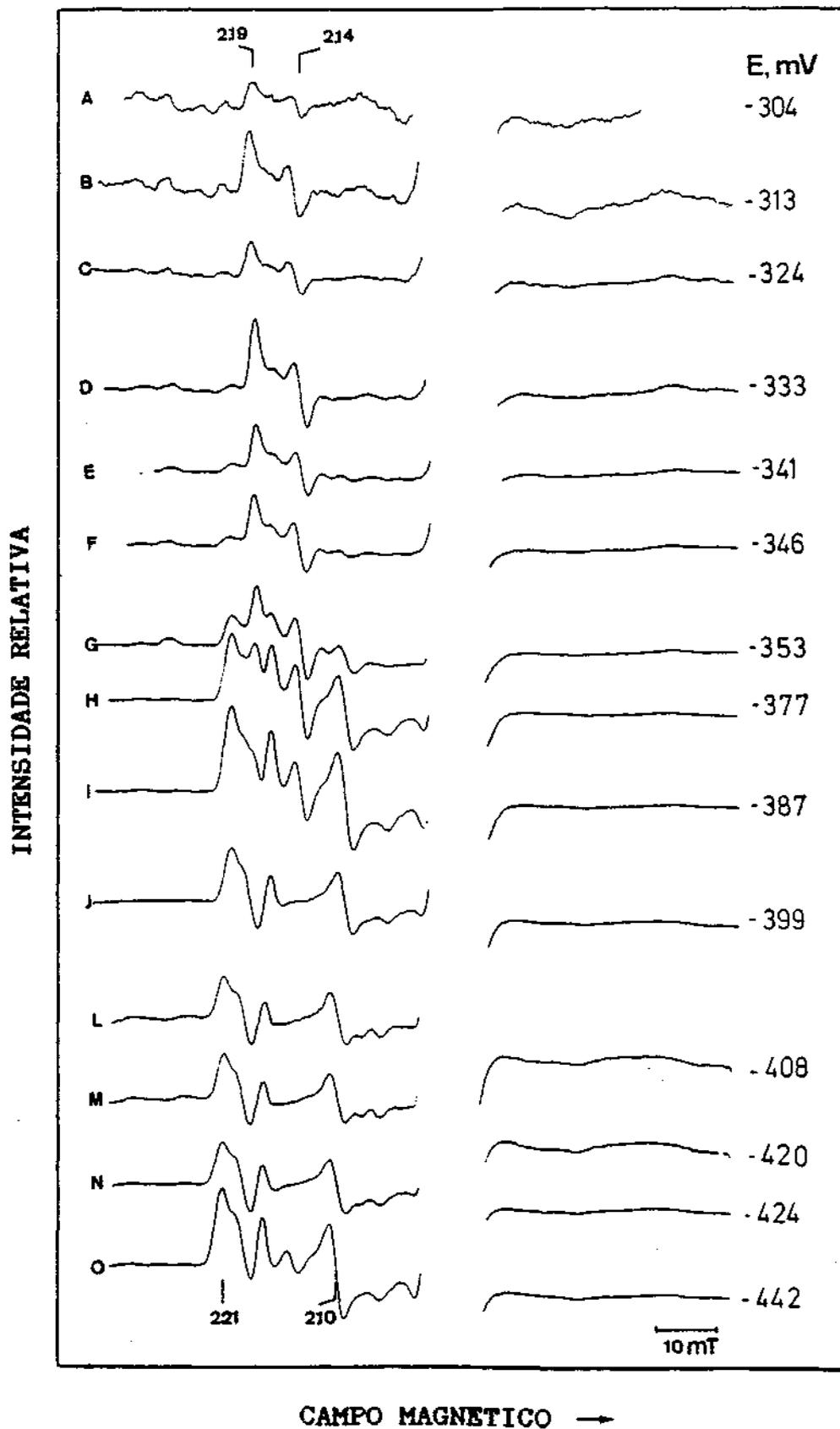
Figura V.35: Evolução dos sinais de RPE a 4 K ao longo da titulação redox sob  $H_2$  da hidrogenase de *D-gigas*
