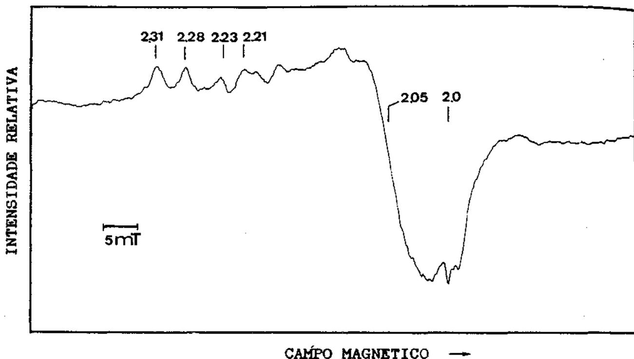
Figura V.23 : Espectro de RPE da hidrogenase de *D.gigas* reduzida sob hidrogênio
