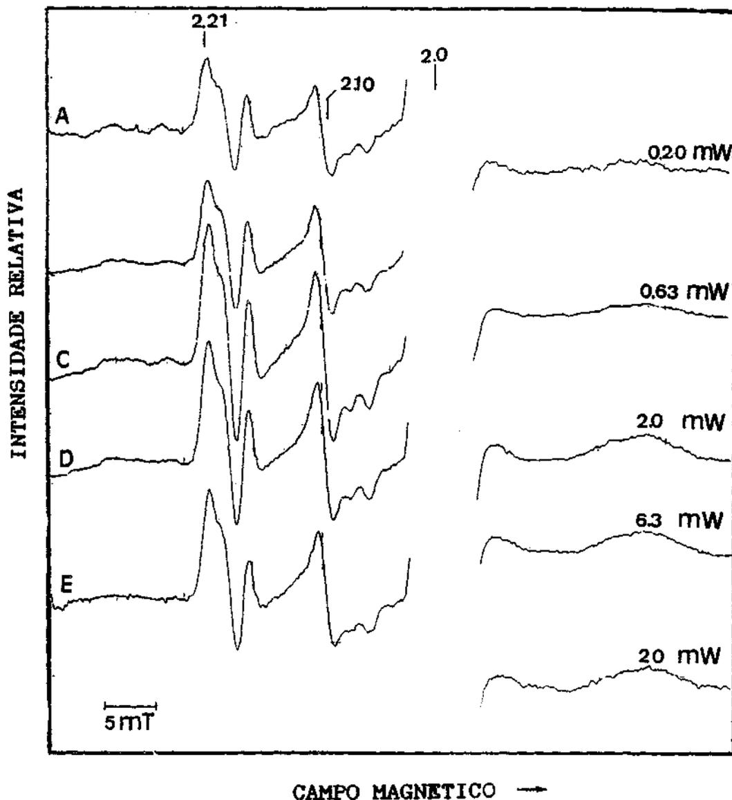
Figura V.40: Variação do sinal de RPE da hidrogenase de *D. gigas* a  $-442$  mV com a potência de microondas
