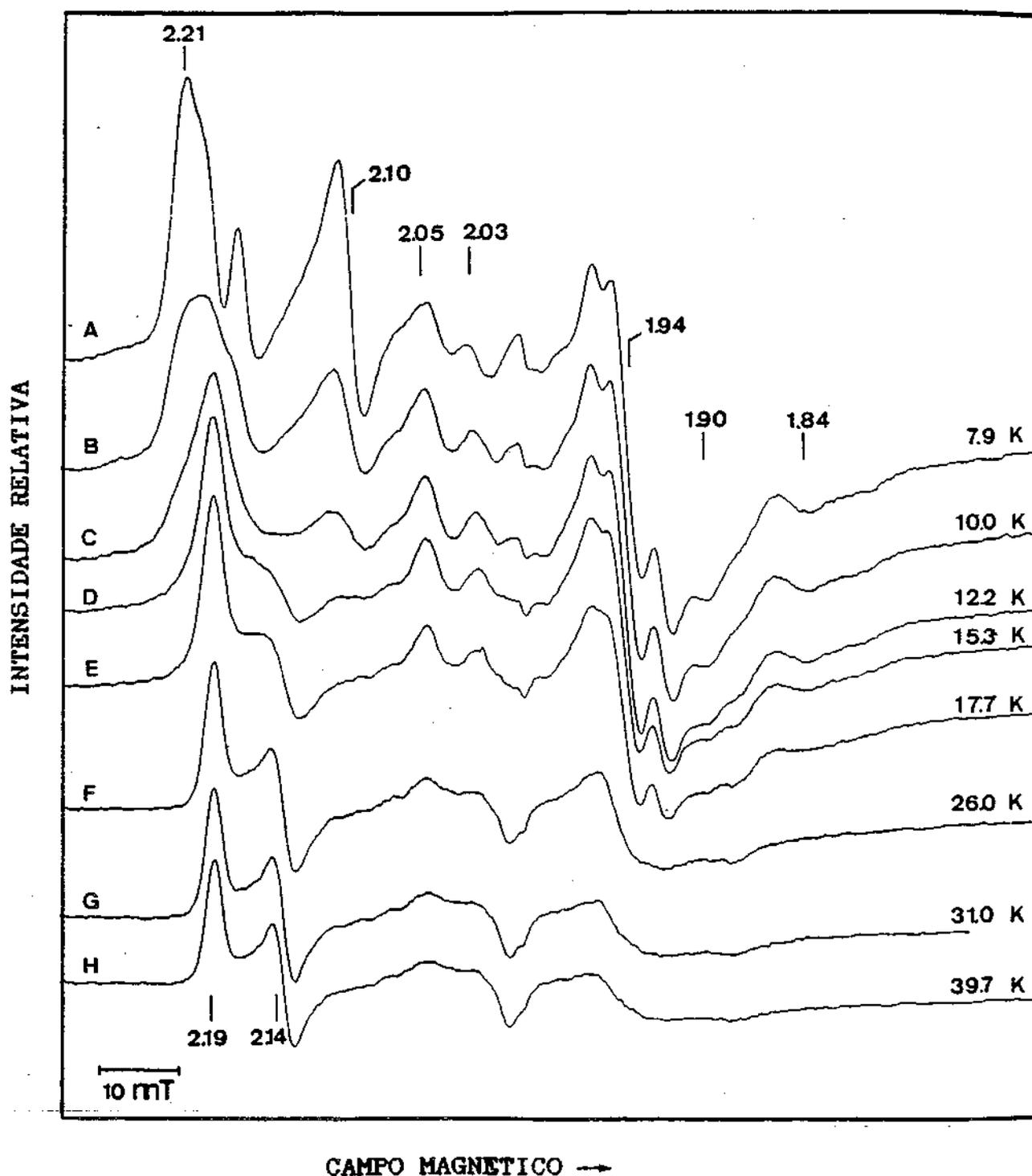
Figura V.22: Sinais de RPE da hidrogenase de *D. gigas* reduzida sob  $H_2$
