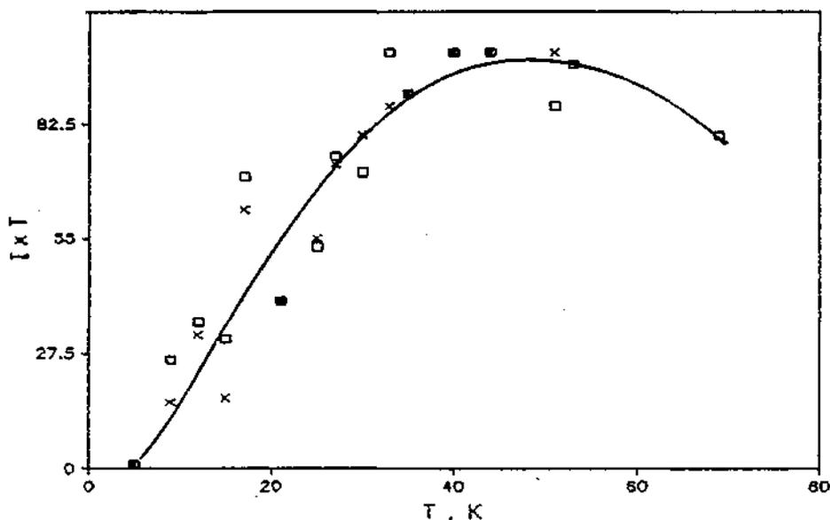
Figura V.10 : Variação da intensidade do sinal Ni-A com a temperatura
