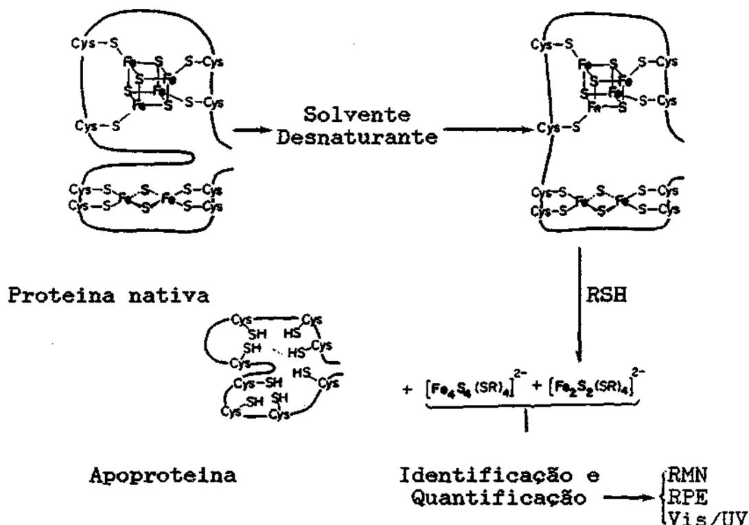
Figura III.8: Representação esquemática das reacções de extrusão (39)
