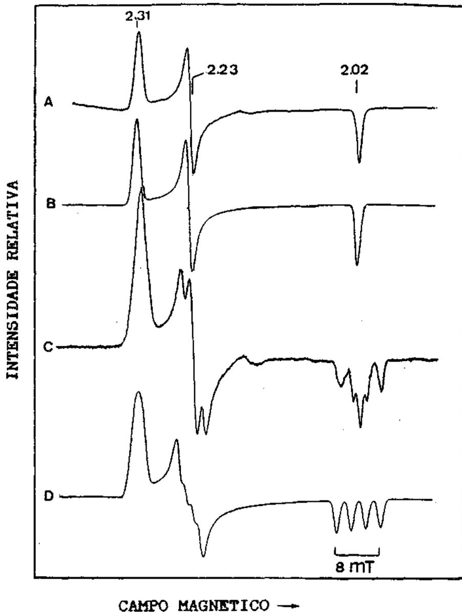
Figura V.9: Sinal de RPE de níquel Ni-A da hidrogenase de *D.gigas*. A,B- Abundância natural de  $^{61}\text{Ni}$ ; C,D- Enriquecida em  $^{61}\text{Ni}$ ; A,C-Sinal real; B,D-sinal simulado. Parâmetros de simulação indicados na tabela V.5. Temperatura: 77 K; Potência: 2 mW; Frequência: 9,28 GHz (A,B) e 9,26 GHz (C,D); Modulação: 1 mT
