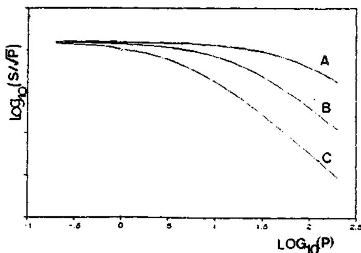
**Figura A.6:** Dependência com a potência de microondas de um sinal de RPE. Curvas calculadas pela equação apresentada no texto para os seguintes valores de  $P_{1/2}$ : A- 100 mW, B- 20 mW, C- 5 mW ( $b=1$ ).
