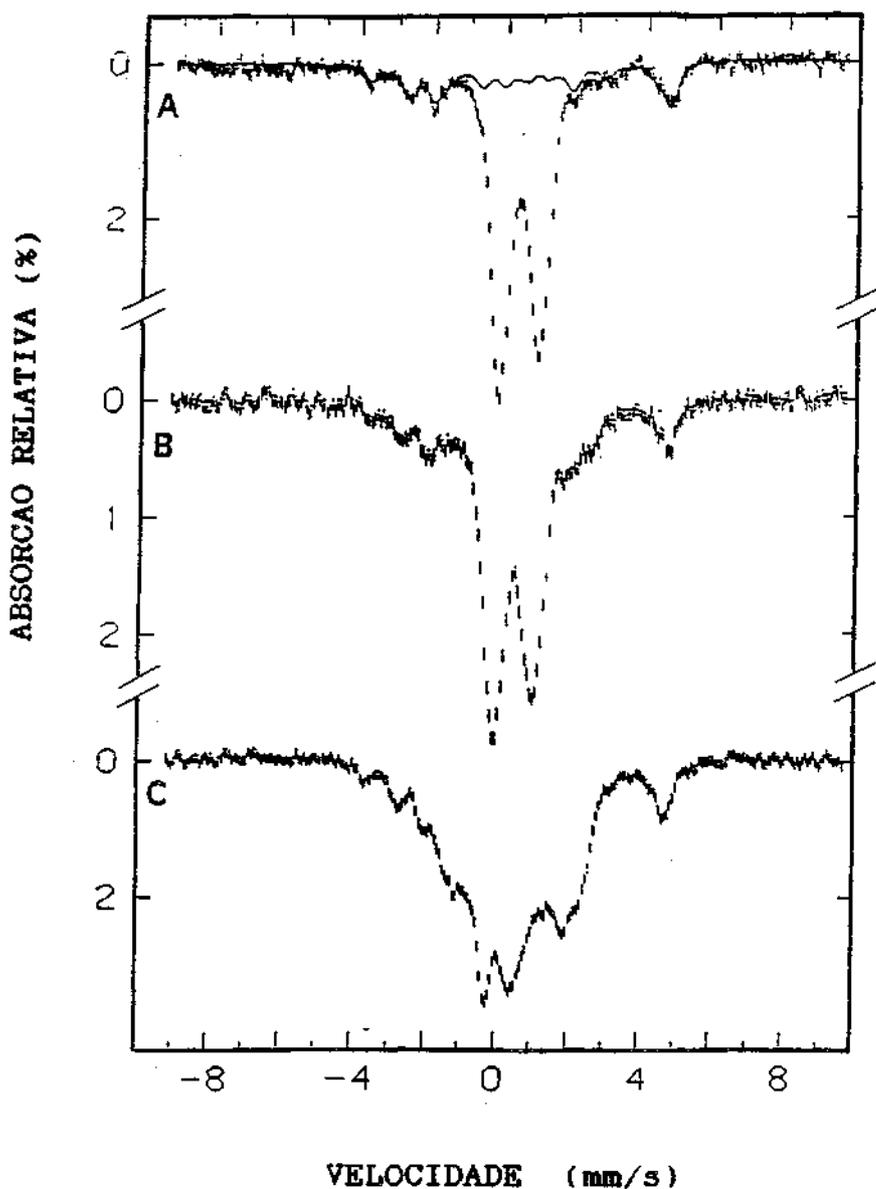
Figura V.25: Espectros de Mössbauer da hidrogenase de *D.gigas* reduzida sob  $\text{H}_2$  a -80 mV (A), -270 mV (B) e -400 mV (C), obtidos a 4,2 K na presença de um campo magnético de 1 T aplicado paralelamente á radiação  $\gamma$ . A linha a cheio é a simulação teórica do espectro do centro  $[3\text{Fe}-x\text{S}]_{\text{red}}$  (9).
