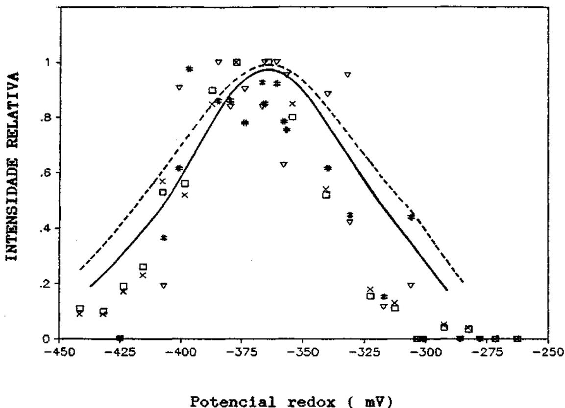
Figura V.43: Curva de titulação redox para o sinal a  $g=2,19$  da hidrogenase de *D. gigas*
