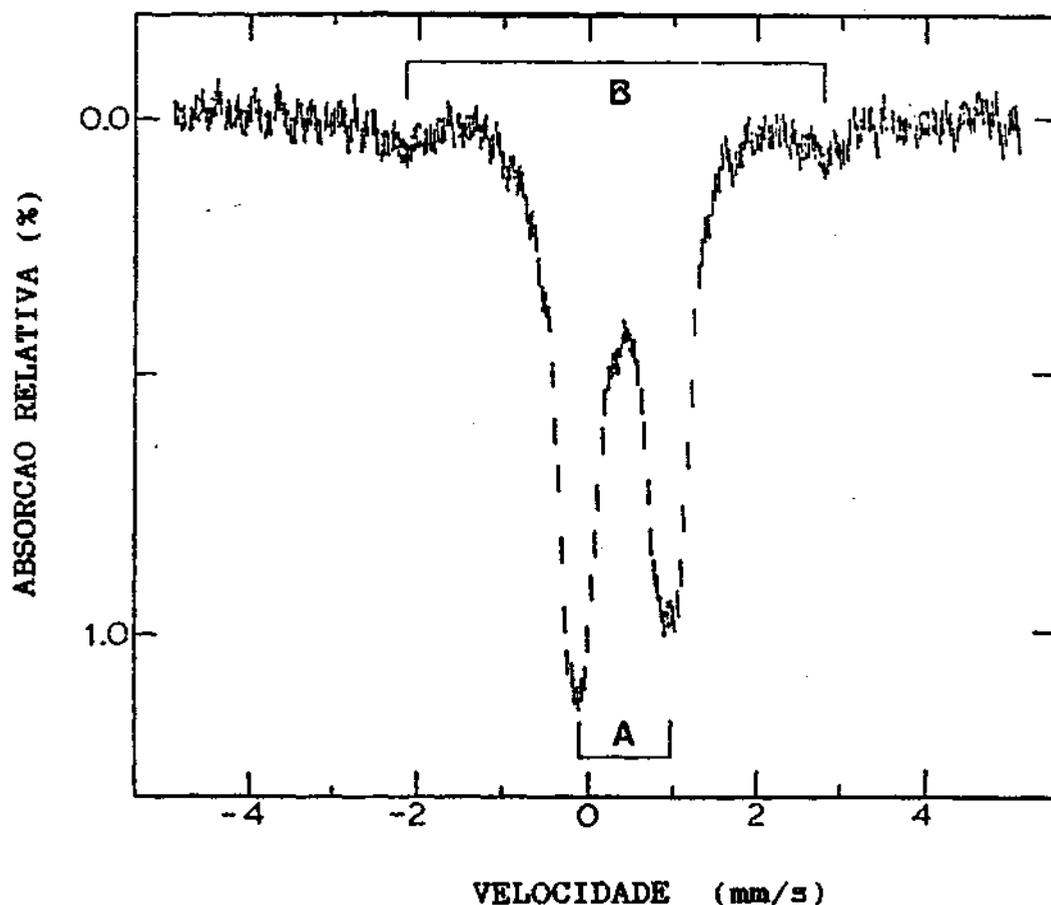
Figura V.4: Espectro de Mössbauer da hidrogenase de *D. gigas* no estado nativo em abundância natural de  $^{57}Fe$ . Temperatura: 4,2 K; Campo magnético aplicado: 50 mT paralelo à radiação  $\gamma$ . Componentes espectrais indicados pelos parêntesis
