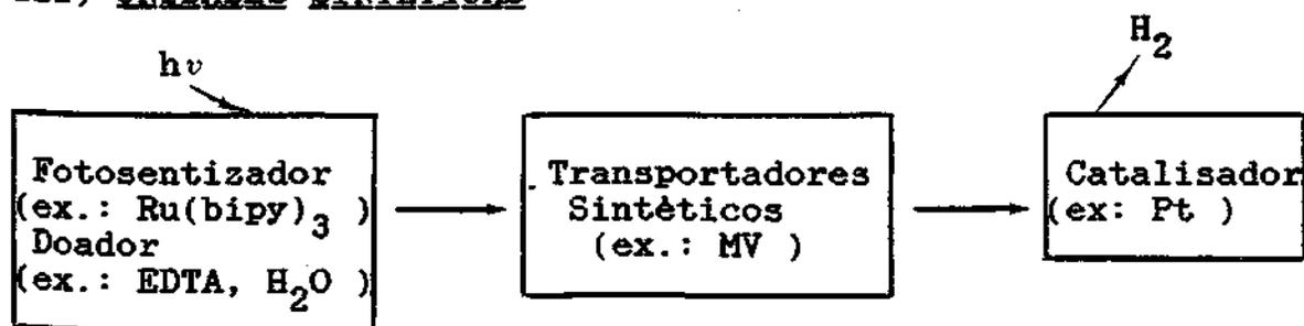
Figura I.7: Sistemas utilizados na fotólise da água
