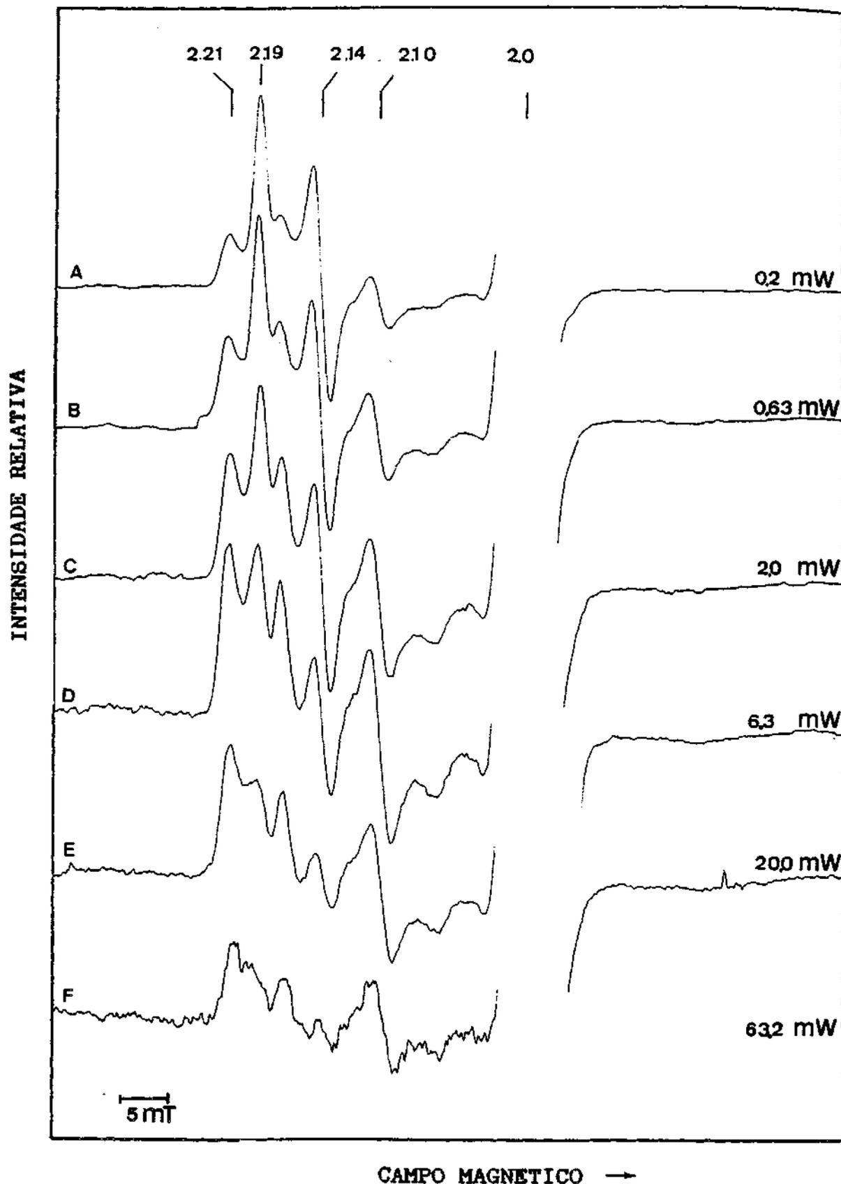
**Figura V.38:** Variação do sinal de RPE da hidrogenase de *D. gigas* a  $-353$  mV com a potência de microondas
