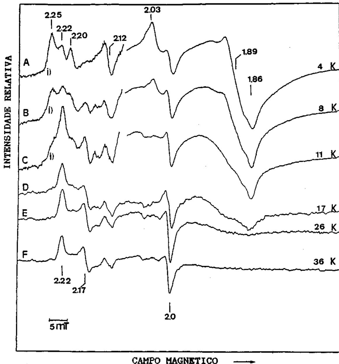
Figura VI.6: Espectros de RPE da hidrogenase citoplásmica de *D. baculatus* reduzida sob hidrogênio. Temperatura e ganho: A-4 K,  $3,2 \times 10^4$ , i)  $10^5$ ; B-8 K,  $3,2 \times 10^4$ , ii)  $10^5$ ; C-10 K,  $5 \times 10^4$ , iii)  $10^5$ ; D-17 K,  $2 \times 10^5$ ; E-26 K,  $2 \times 10^5$ ; F-36 K,  $2 \times 10^5$ . Outras condições como na Figura VI.2
