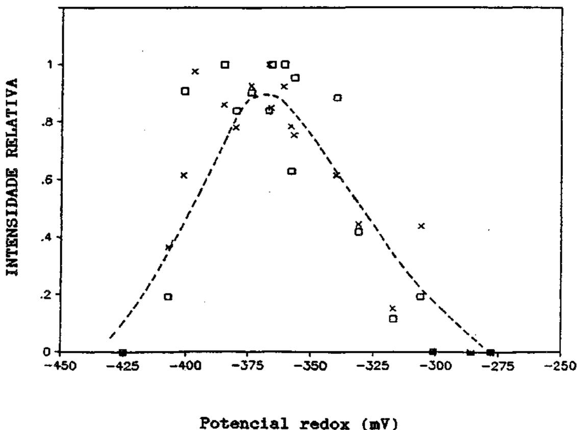
Figura V.33: Titulação redox do sinal a  $g=2,19$  da hidrogenase de *D.gigas* por adição de ditionito de sódio. Intensidade relativa do sinal a  $g=2,19$  (□) e a  $g=2,14$  (X), a 77 K, em função do potencial redox, a  $\text{pH}=8,5$
